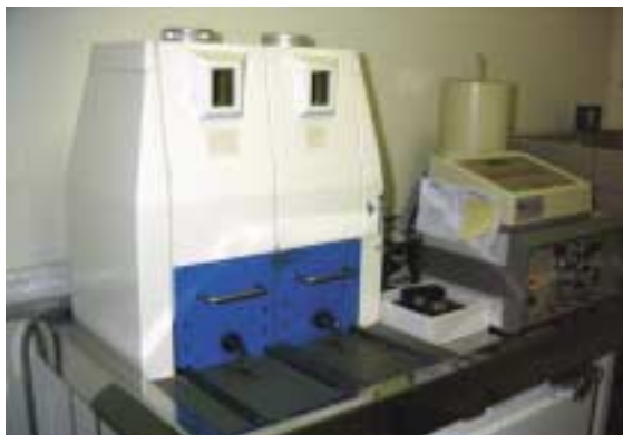
Technetium-Generator in einer radiologischen Praxis
